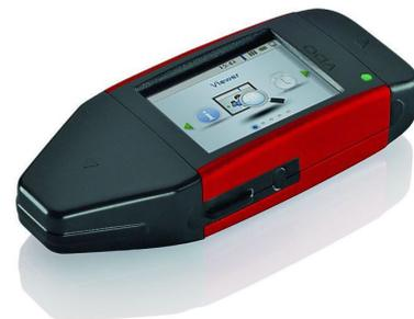
DLKPro TIS-Compact® позволяет выполнить загрузку данных из памяти тахографа и карт. Анализ выполняется оперативным образом с отображением данных на экране самого прибора или на экране компьютера. Простая визуализация и указание на наличие нарушений обеспечивают удобную и комфортную работу с устройством.
